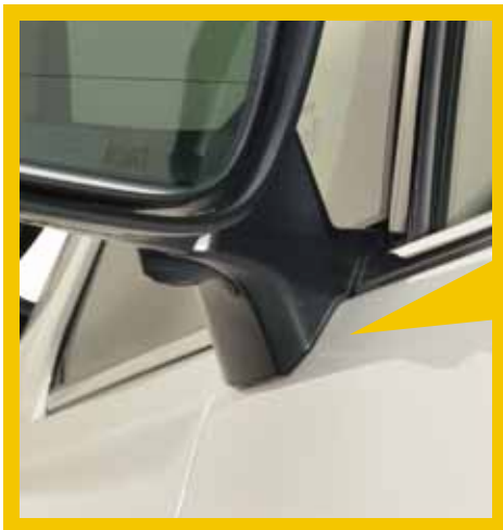
正しい取付け状態(後方から見た状態)
