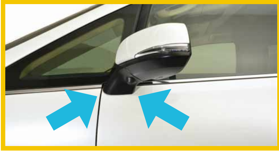
正しい取付け状態(前方から見た状態)
