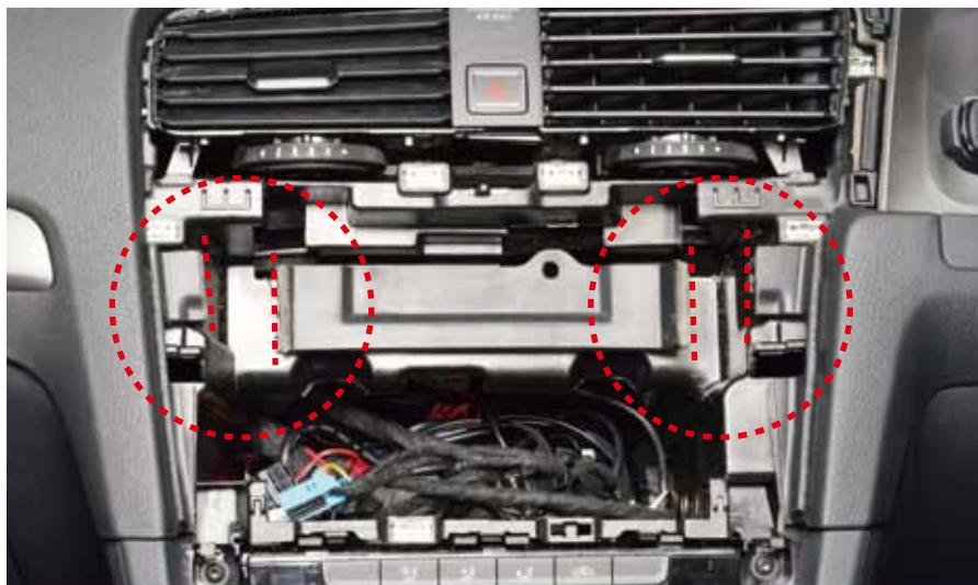
○印内の…破線に沿って小型グライダー等を使用し、切り取りを行います。写真は切り取り加工後の状態です。
