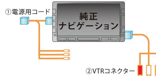
本キットに付属の②VTRコネクタを使用することにより、ホンダの純正ナビゲーションにVTR機器を接続することが可能になります。市販のDVDプレーヤー、ビデオカメラ、ビデオゲームや、今話題の地上デジタルチューナーなどを接続できるようになり、大変便利です。また、接続する機器に供給する電源も、①電源用コードを使用してナビゲーション取付部奥から簡単に取出すことができます。
